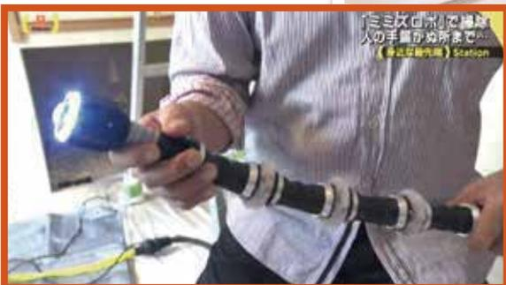
日本ウイントン株式会社は、中央大学および立命館大学と共同研究を行い、世界初の空調・換気ダクト点検清掃ロボットを開発いたしました。このロボットを使うことで、これまで十分に点検・清掃することができなかったダクトの奥まで、きちんと点検・清掃をして、快適で健康的な室内空気環境を目指します。
